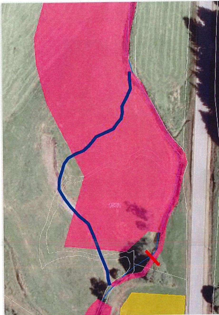
Abbildung 3: geplante Bachrückverlegung des Rohrbachs in die Talaue, rot der bestehende Sohlabsturz (Quelle: RIPS Daten LU BW 2018)
